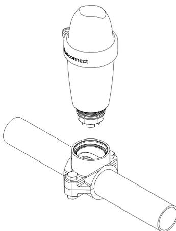
2. Fermez le collier de prise en charge avec le bouchon fourni dans la boîte du **Blue Fit50**.
