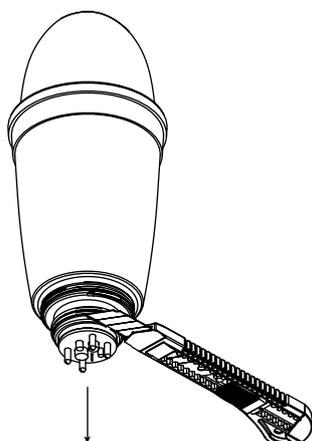
7. Retirez la sonde en veillant à garder **Blue Connect** en position verticale (avec la partie supérieure de l'appareil au-dessus et la partie inférieure en-dessous) afin que de l'eau résiduelle ne rentre pas dans le produit. Veillez à retirer le joint et jetez-le. Il pourrait être bloqué à l'intérieure.
